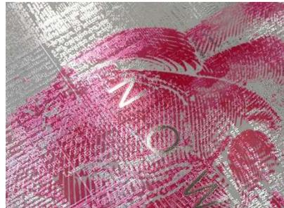
Dank der digitalen Metallisierung und der „Transfer on Toner“-Technologie wird eine perfekte Registrierung nahtlos erreicht, wodurch sichergestellt wird, dass die Metallisierung bei jeder Anwendung präzise mit dem Druckerzeugnis übereinstimmt.
