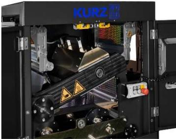
Das **IR-Heizsystem** ist ein Beispiel für **Spitzentechnologie** und bietet eine präzise **Temperaturregelung mit patentiertem Kühlabschnitt**, der eine gleichmäßige Trägerfreigabe gewährleistet. Diese Innovation verkürzt die Zeit, die Oberflächen benötigen, um die optimale Temperatur zu erreichen, sodass die Maschine **in nur 10 Minuten betriebsbereit** ist. Die Silikon-Auftragswalze
